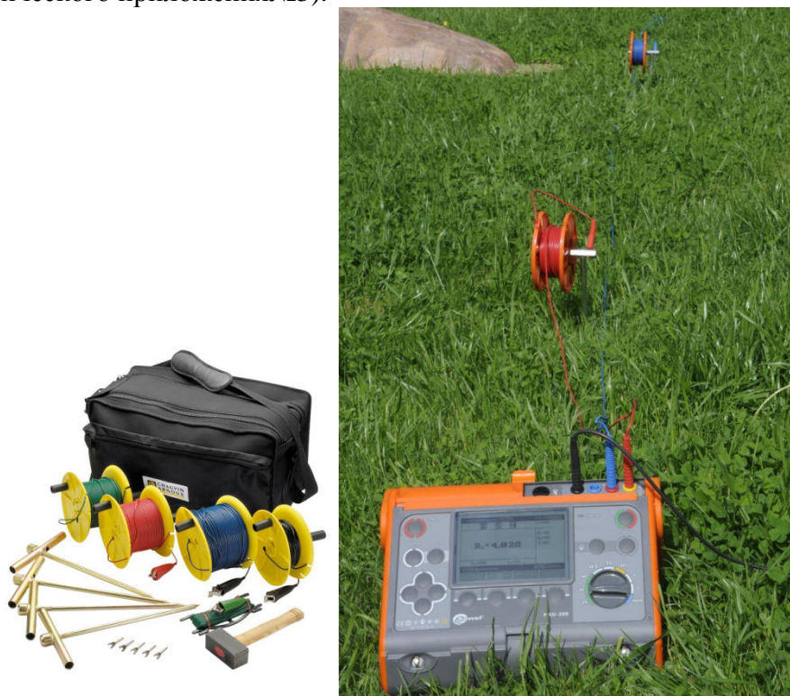
Рис. 1 – прибор для определения электрического сопротивления грунта в полевых условиях.
