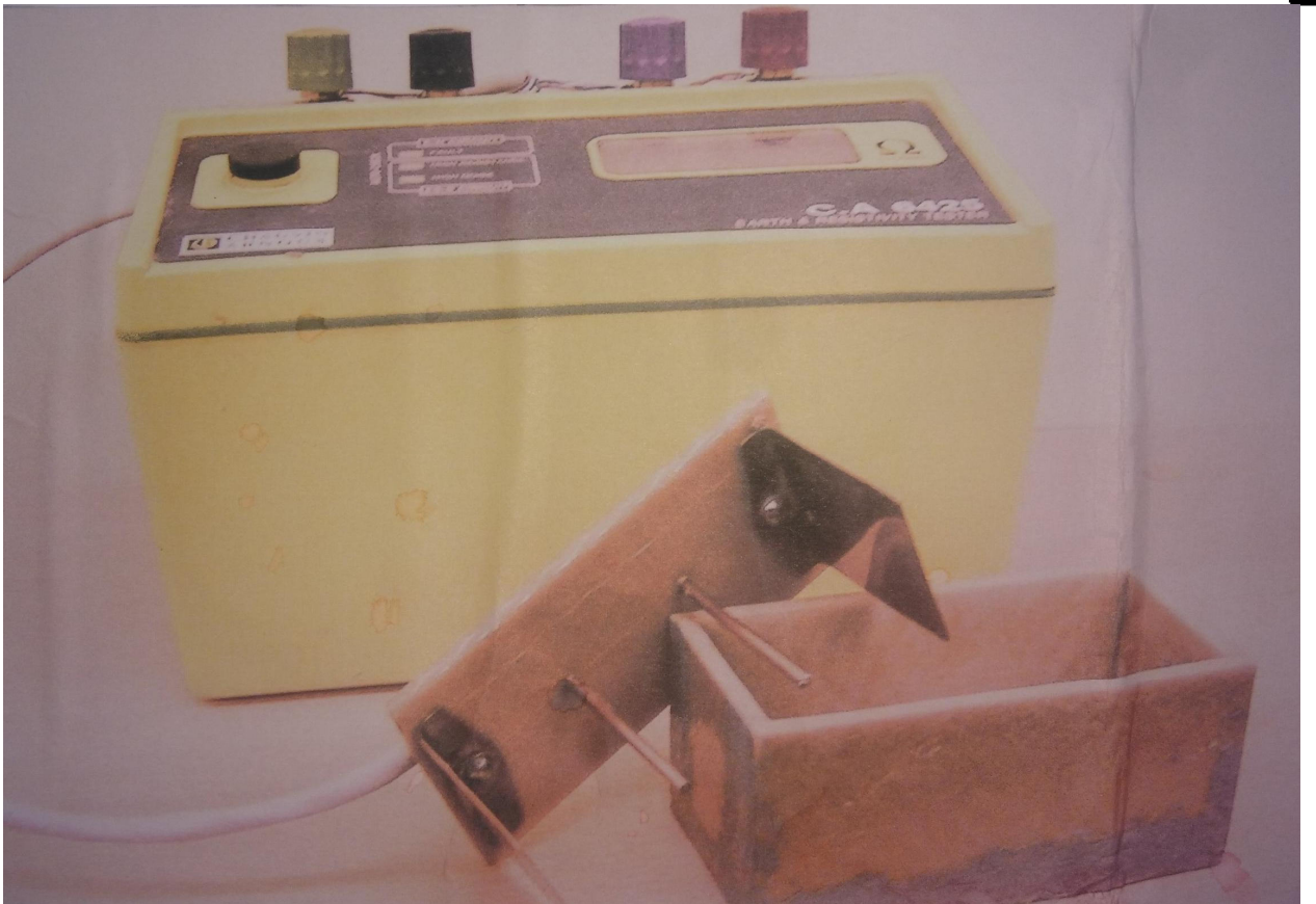
Рис. 2 – Прибор С.А. 6425 для измерения электрического сопротивления грунта в лабораторных условиях.
