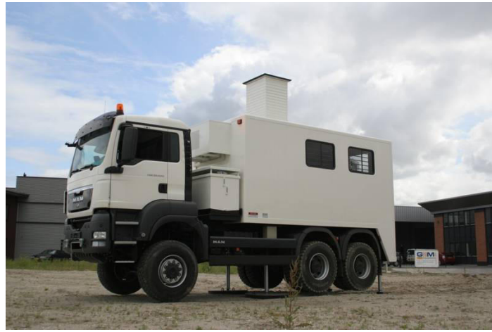
Рис. 8 – Установка статического зондирования на базе автомобиля GeoMil
