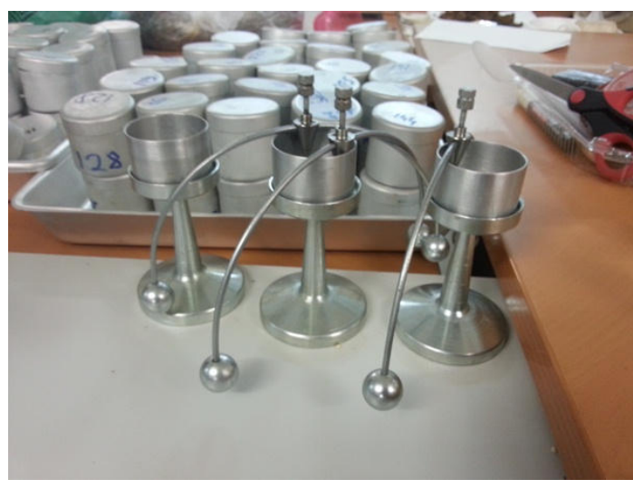
Рис. 17 – Балансирный конус Васильева Компрессионные испытания
