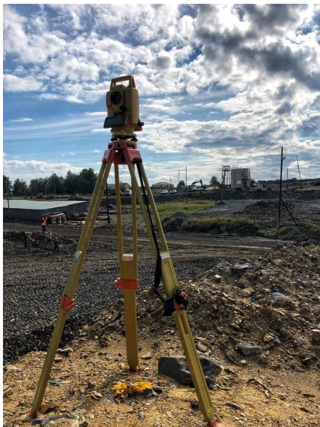
Приложение №7 Тахеометрическая съемка в карьере
