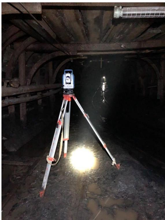
Приложение №6 Тахеометрическая съемка в шахте
