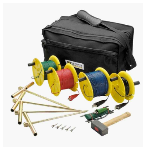
Рисунок 2. 4-х электродная установка УЭС
